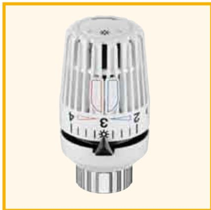
Термостатическая головка фирмы «HEIMEIER» разработана для установки на радиаторах со встроенным клапаном. Зажимное устройство с предохранительным кольцом обеспечивает непосредственное соединение с термостатическими клапанами без соединительного разъема с резьбой M 30 x 1,5. Термостатическая головка VK может быть установлена в различных положениях, смещенное друг относительно друга на 90°.
